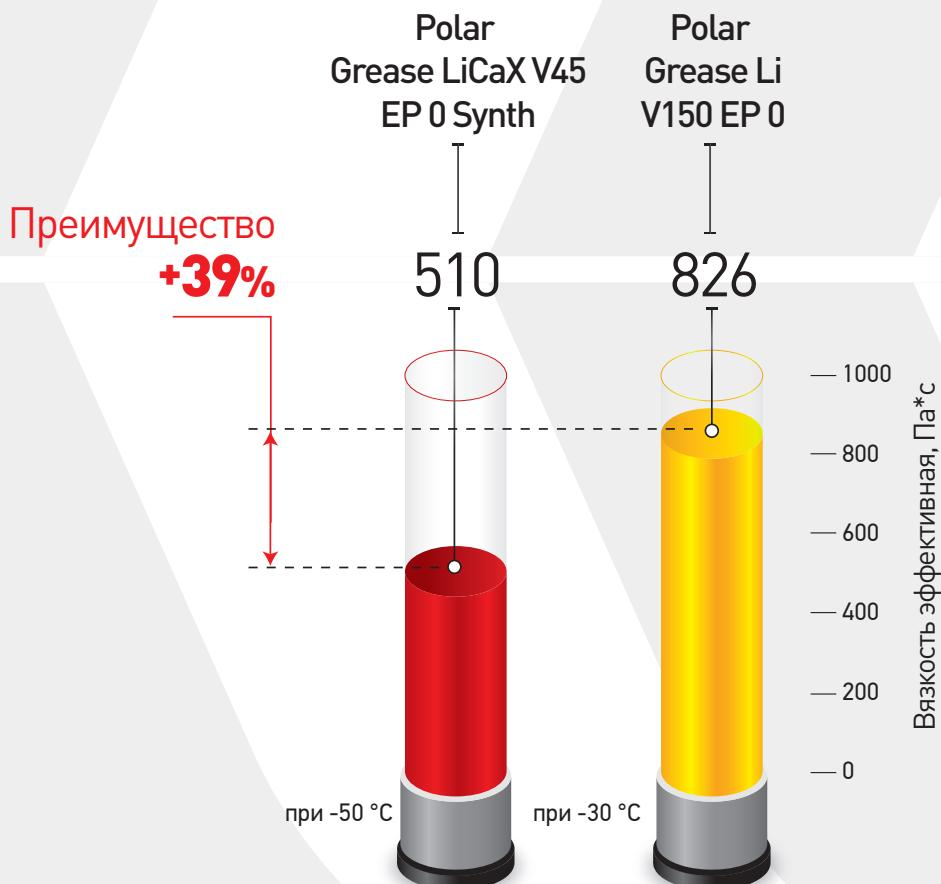
**Devon Polar Grease LiCaX V45 EP 0 Synth** – синтетическая морозостойкая смазка для применения в централизованных системах смазывания узлов шасси.
